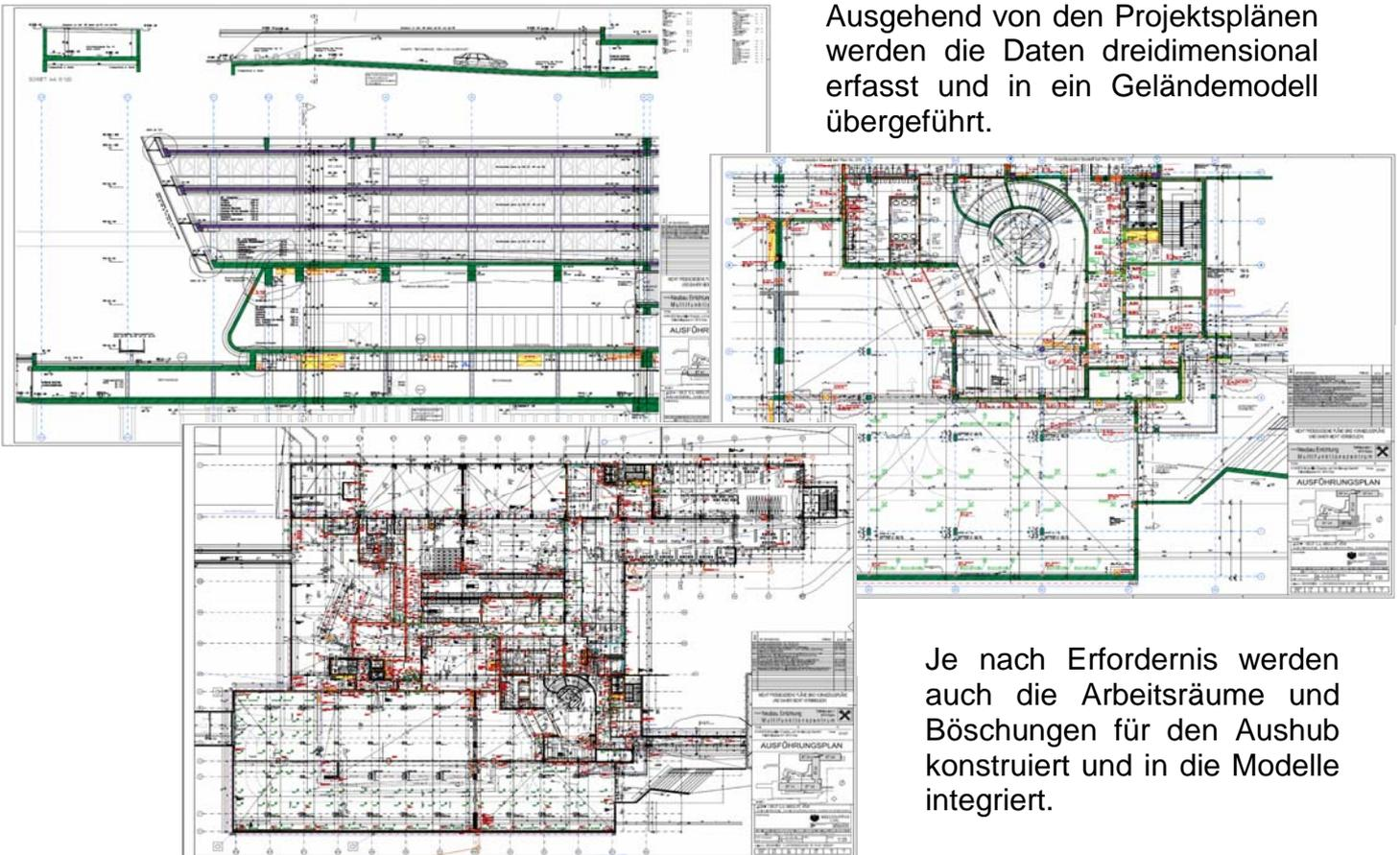
Je nach Erfordernis werden auch die Arbeitsräume und Böschungen für den Aushub konstruiert und in die Modelle integriert.
